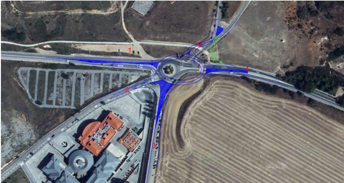
Figura 12: Esquema preliminar de nueva glorieta, base para estimar los requerimientos de suelo para la ejecución del nuevo acceso. Fuente: Documento de Avance PRAT
